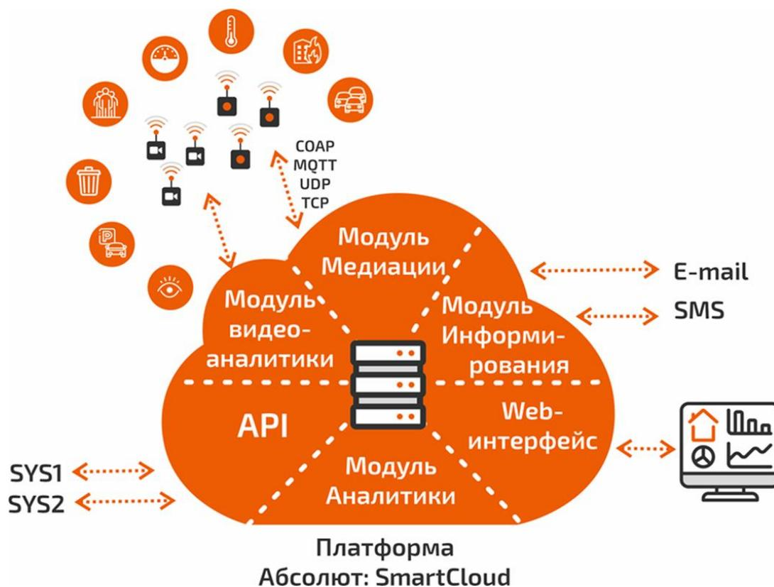
Рис. 1 Архитектура платформы «Абсолют: SmartCloud»
