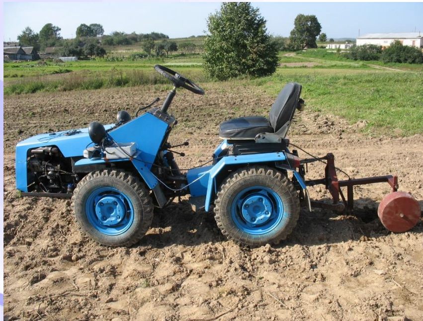
Прицепное устройство для установки датчика определения спектральных характеристик почв
