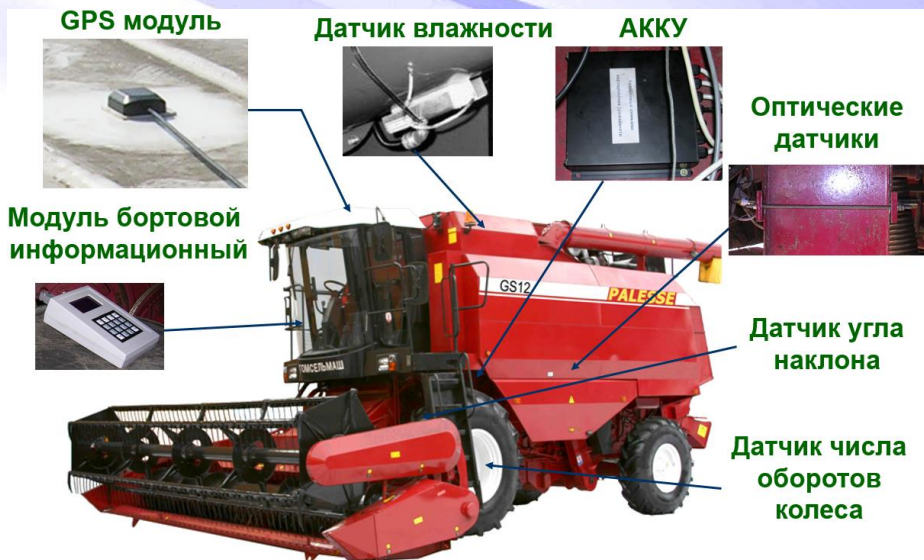
Установка оборудования программно-технического комплекса картирования урожайности
