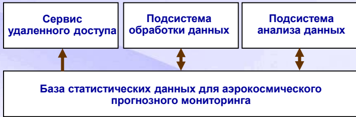
Общая схема универсальной цифровой платформы
