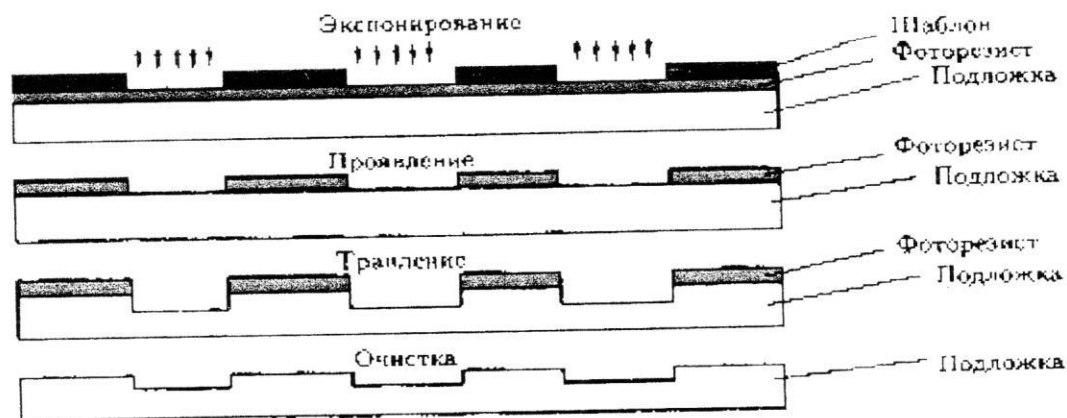
Рис. 1. Процесс формирования микрорельефа в подложке
