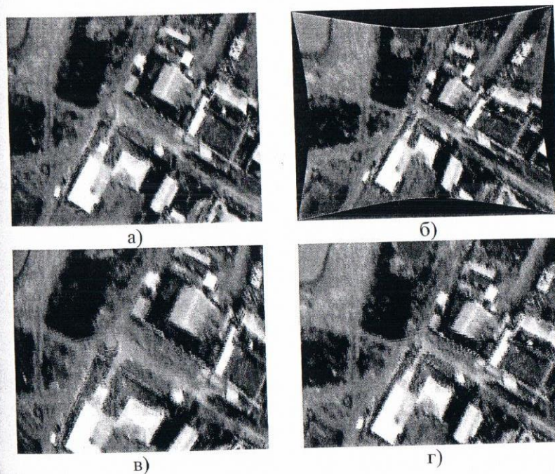
Рис. 7. Пример обработанного кадра видео потока: а) исходный кадр ; б) «подушка» ; в) «бочка» ; г) последовательно «подушка» и «бочка»
